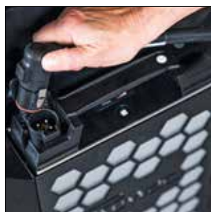
Koppla ur stickkontakten och ta enkelt bort batteriet
